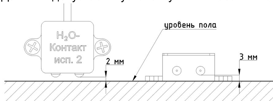
После монтажа датчика необходимо проверить работоспособность датчика. В процессе технического обслуживания рекомендуется ежеквартальная очистка наружных контактов датчика от загрязнений, применение абразивных и химически активных веществ при этом не допускается. На время профилактики рекомендуется отключить систему для предотвращения ложных срабатываний.
