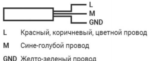
Рис. 2 Схема подключения
