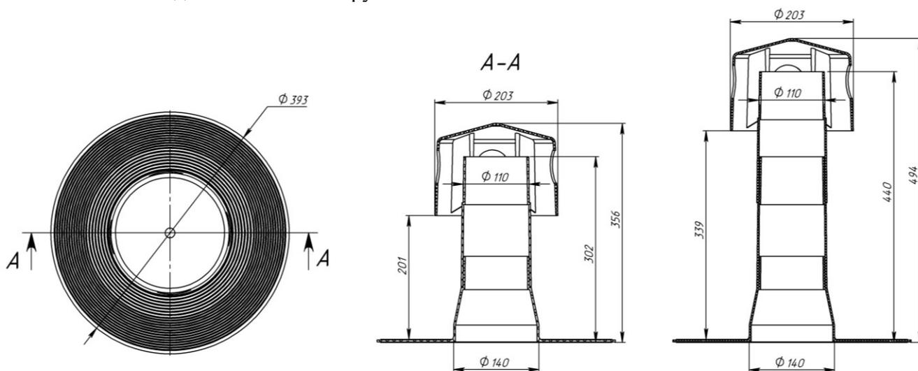
Рис. 1. Схема аэратора
